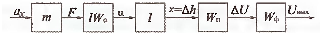
Рисунок 8.4 – Блок-схема измерительной цепи маятникового акселерометра
